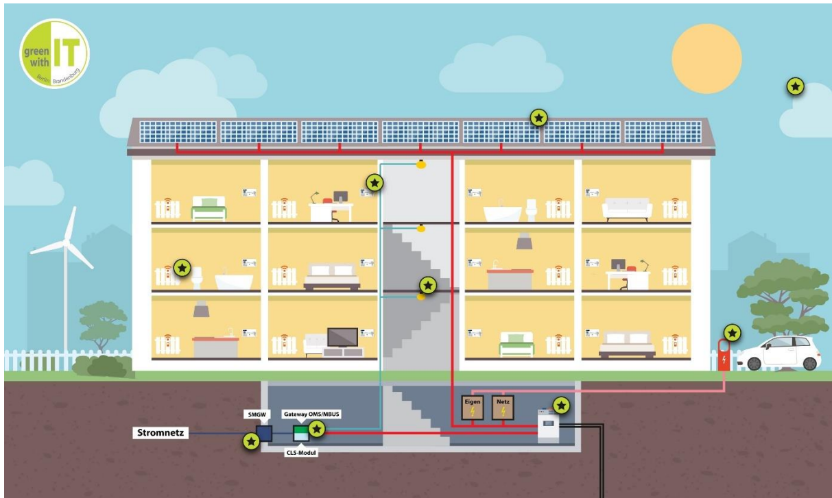
Abbildung 12 Das CLS-Modul als Sammelstelle digital erfasster Verbrauchswerte Anlagen und Dekarbonisierung, Quelle: green with IT
