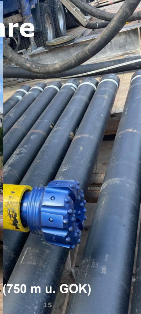
Bohrarbeiten für einen mitteltiefen Erdwärmespeicher in (750 m u. GOK)
