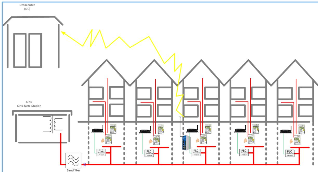
Abb. 29: Installationsort PLC Headend und WAN Schnittstelle, © green with IT e.V.
