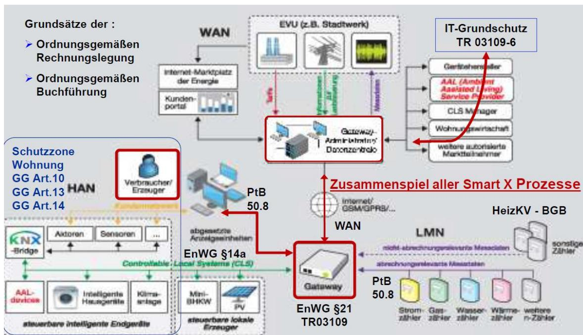
Abb. 22: Smart Meter Gateways, Nutzungsebenen im Gebäude und Datenschutz, Quelle: Rolf Uhlig
