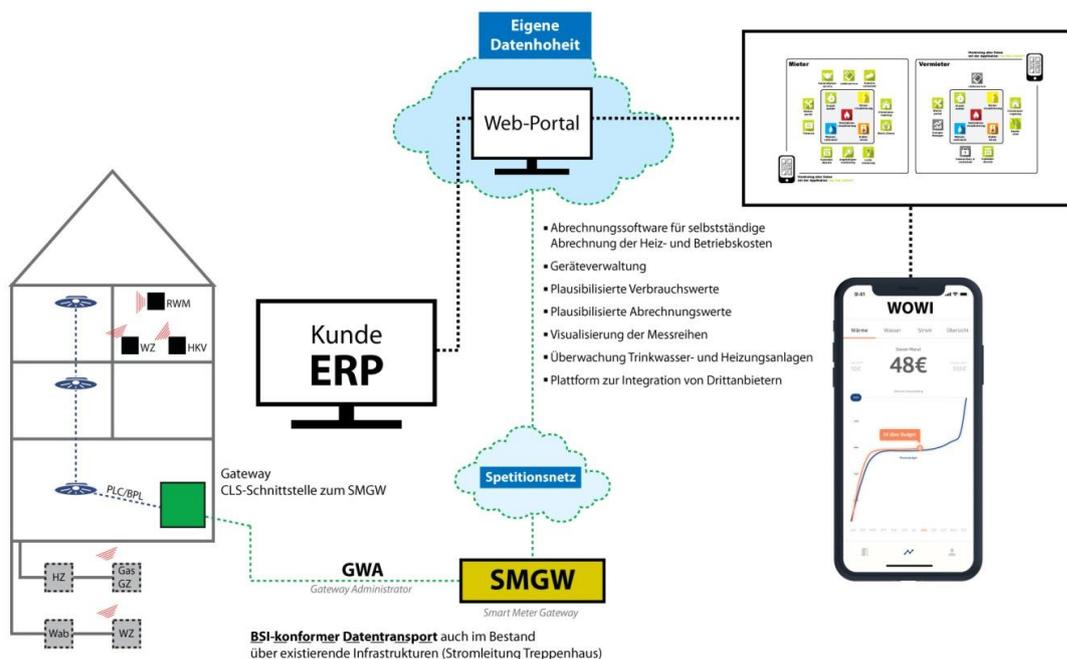
Abb. 6: Schaubild angestrebte digitale Quartier- Erschließung B2B (Vermieter) und B2C (Mieter) unter Einsatz eines lichtgeführten telemetrischen Etagen-Sammelsystems© green with IT e.V.
