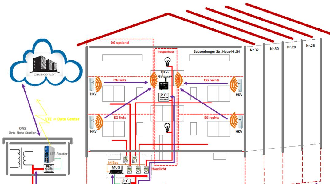
Abb. 33: Kommunikationskonzept HKV Datenübertragung über IKT-WAN Speditionsnetz,
