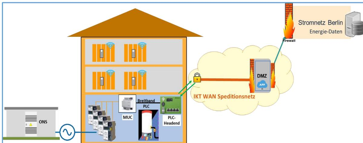
Abb. 36: Kommunikationskonzept Pilotobjekte Sausenberger Straße 26-34; 1. Evaluationsstufe mit MUC und Standard PLC-Kommunikation, © green with IT e.V.
