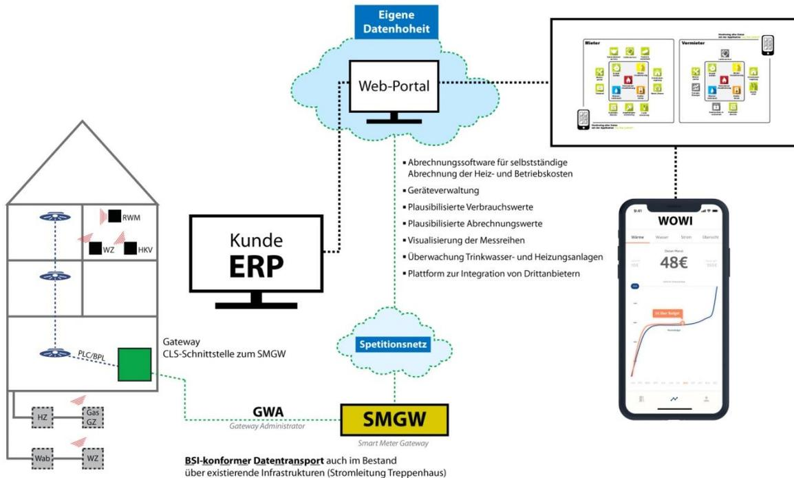
Abb. 55: vollautarke, nach common criteria datensichere Quartierlösung inkl. einer telemetrischen Sammelfunktion je Stockwerk im Treppenhaus auf Strombasis, © green with IT e.V.
