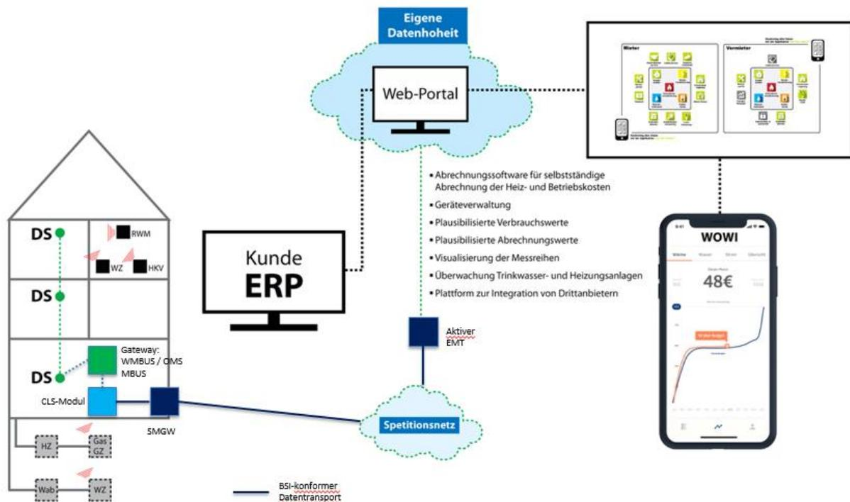
Abb. 41: Autarke Wertschöpfung inkl. Gateway und SMGW im Wohnungsunternehmen, hier bereits mit BSI-konformer Datensicherheit nach common criteria, Wärme-App für Mieter, vorbereitet für umfassende WoWi-App, © green with IT e.V.
