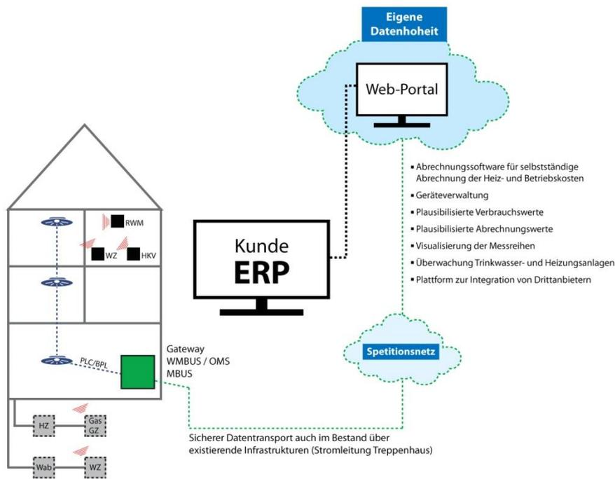
Abb. 28: Voll autarkes Gateway-System, hier: unter Nutzung der vorhandenen Stromleitungs-Infrastruktur Treppenhaus, © green with IT e. V.
